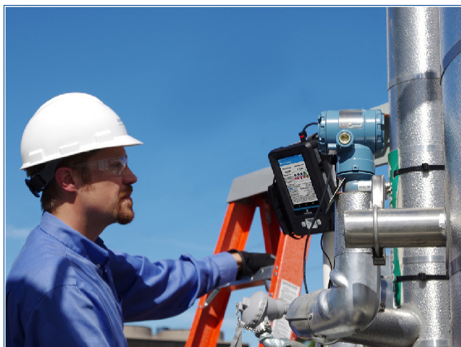
マグネットハンガーアクセサリにより、Trexユニットをパイプに取り付けることができるため、他の作業のために両手を空けることができます。
